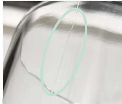
金型の痕跡・継ぎ目
