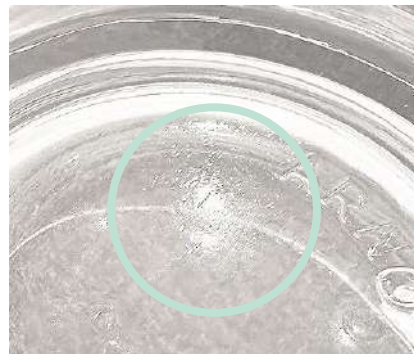
底面の気泡痕テクスチャー
