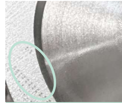
加工の圧力によるプレス痕
