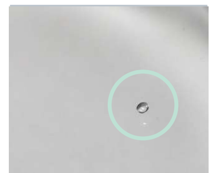
気泡および気泡の裂け跡
