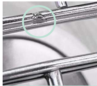
溶接部分の仕上がりの差
